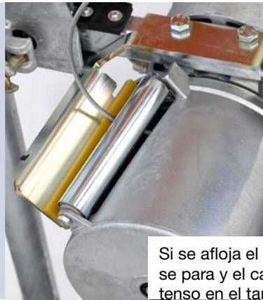
Si se afloja el cable, el motor se para y el cable permanece tenso en el tambor
